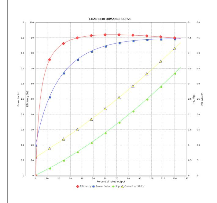
Performance : 380 V 50 Hz 2P IE2 : 34.7 A Rated current Moment of inertia (J) : 0.1086 kgm<sup>2</sup> **LRC** : 5.3 Duty cycle : Cont.(S1) : F Rated torque : 6.21 kgfm Insulation class Locked rotor torque : 180 % Service factor : 1.00 Breakdown torque : 180 % Temperature rise : 80 K Rated speed : 2920 rpm Design : B
