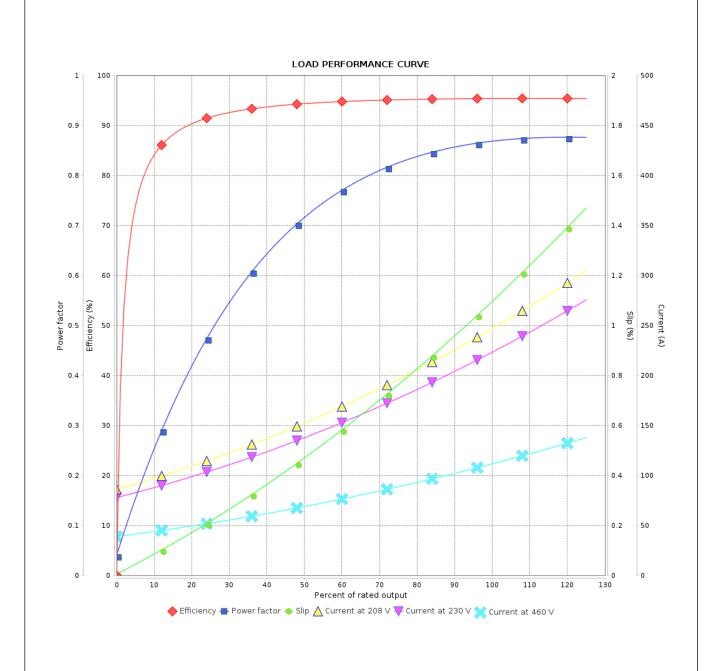
Performance : 230/460 V 60 Hz 4P : 226/113 A Rated current Moment of inertia (J) : 1.11 kgm<sup>2</sup> **LRC** : 7.2 Duty cycle : Cont.(S1) : 40.8 kgfm : F Rated torque Insulation class Locked rotor torque : 270 % Service factor : 1.15 Breakdown torque : 280 % Temperature rise : 80 K
